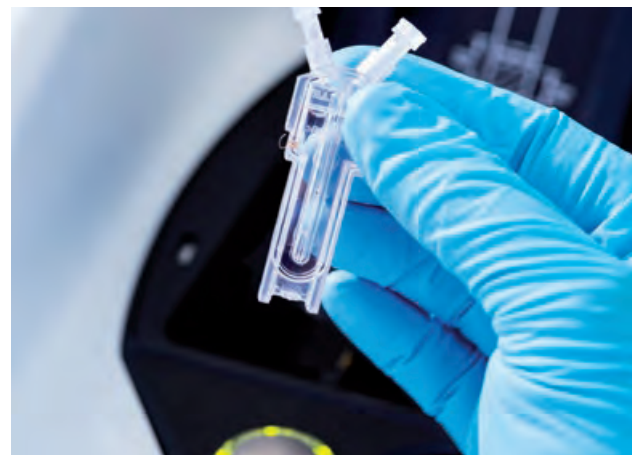
ABBILDUNG 7 Mittels Dynamic Light Scattering wird der Durchmesser der Liposomen gemessen.
