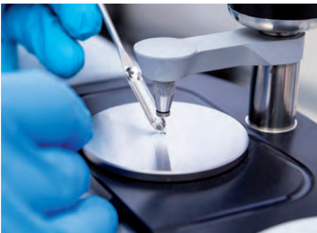
ABBILDUNG 6 Das Infrarot-Spektrometer dient der Vorprüfung sämtlicher Rohstoffe hinsichtlich Qualität und Reinheitsgrad. Nach bestandener Prüfung erfolgt die Freigabe der Rohstoffe für die Produktion.
